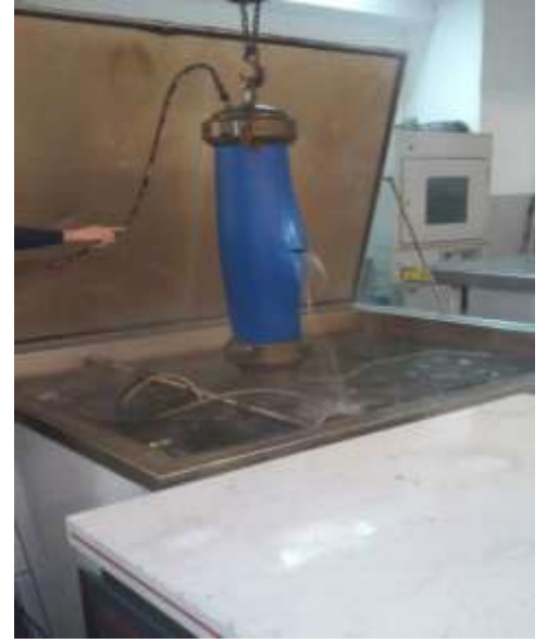
İçme suyu hatlarında kullanılan PE boruların muayene aşamaları
