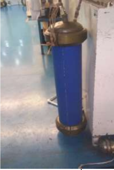
İçme suyu hatlarında kullanılan PE boruların muayene aşamaları
